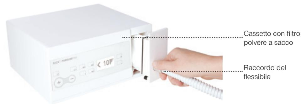
L'apparecchio ricorda all'utente di sostituire il filtro polvere a sacco. Si consiglia tuttavia di controllare il livello di riempimento del filtro una volta alla settimana. Per sostituire il filtro polvere a sacco, premere il tasto [ i ] per accedere al MENU INFO. Qui sfogliare con il tasto [ + ] o [ - ] fino alla voce di menu Sostituzione filtro:
