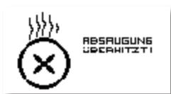
"SURRESCALDAMENTO ASPIRAZIONE" - Al superamento della temperatura dell'aria nell'alloggiamento della turbina di aspirazione, la turbina e il manipolo verranno disinseriti. Dopo l'abbassamento della temperatura di circa 10...15 °C, questa indicazione sul display scomparirà e sarà possibile reimpostare la velocità del manipolo.
