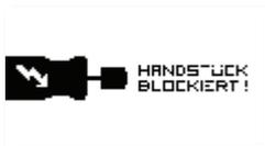
"MANIPOLO BLOCCATO!" - Se si blocca il manipolo, dopo circa 5 secondi viene disinserita la velocità motore e la turbina di aspirazione. Dopo circa 10 secondi, questa indicazione sul display scomparirà e sarà possibile reimpostare la velocità del manipolo.
