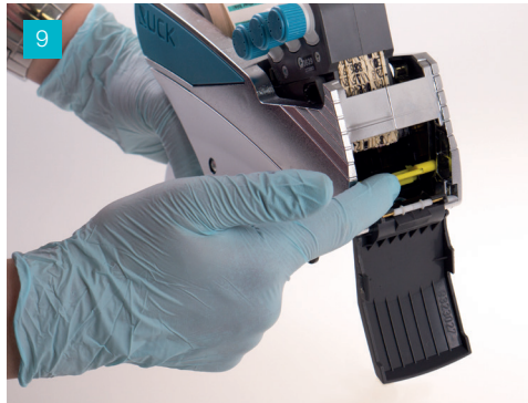
Farbrolle rutscht in die Halterung
