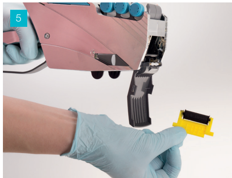
5 Neue Farbrolle, Aufschrift TOP muss oben sein
