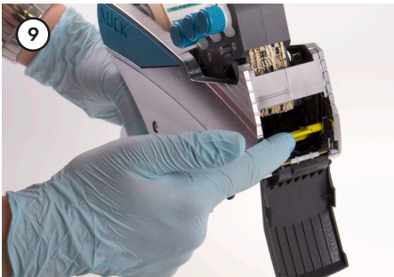
9 Die Farbrolle rutscht in die Halterung.
