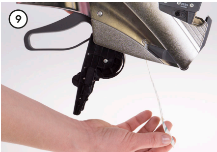
Ersatzetiketten durch das Gerät ziehen.
