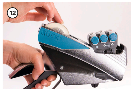
Etikettenrolle zurückziehen bis das Band straff anliegt.
