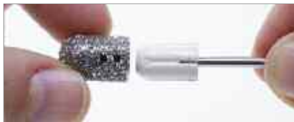
Abb. 2.9: Aufsetzen der Schleifkappe auf das Trägersystem. Die beiden schwarzen Punkte zeigen an, an welcher Stelle die Kappe in die Führungsnut geschoben werden muss.
