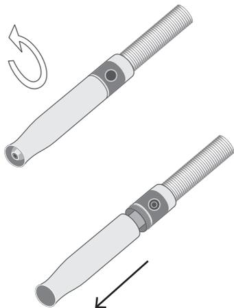
Ziehen Sie vorsichtig die Hülse ab, indem Sie gleichzeitig gegen die Metallkappe des Spannftutters drücken.
