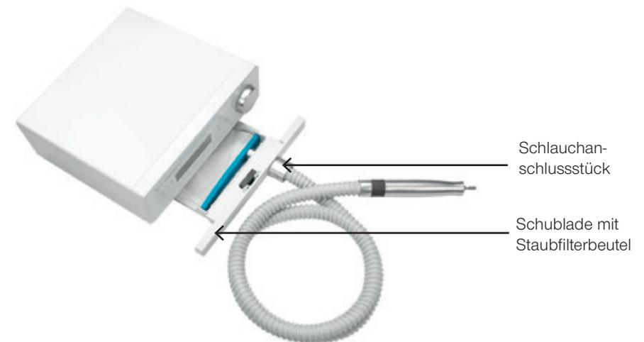
Das Gerät erinnert Sie an den Wechsel des Staubfilterbeutels. Dennoch wird empfohlen den Füllstand des Filters einmal pro Woche zu kontrollieren. Zum Wechseln des Staubfilterbeutels drücken Sie die [ i ] - Taste um ins INFOMENÜ zu gelangen. Dort blättern Sie mit der [ + ] oder [ - ] - Taste bis zum Menüpunkt Filterwechsel:
